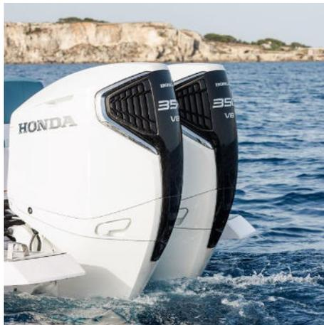
Le moteur BF350 est propulsé par un moteur V8 de 5 litres, ouvert à 60 degrés, est doté de la technologie de contrôle électronique VTEC™ (Variable Valve Timing and Lift Electronic Control) exclusive Honda. Pour le confort de navigation, le niveau de bruit et de vibration du BF350 est particulièrement faible, tout en offrant une sensation de conduite sportive.
