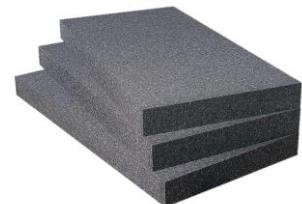
Grâce à l'expertise du centre de recherche intégré de HIRSCH Isolation, Maxidall Ultra affiche une excellente conductivité thermique ( $\lambda = 31 \text{ mW/m.K}$ ) et une résistance thermique parmi les meilleures du marché : jusqu'à **R = 4,00 m<sup>2</sup>.K/W pour une épaisseur de 123 mm sous dallage, jusqu'à R = 8,15 m<sup>2</sup>.K/W pour une épaisseur de 250 mm sous chape.**
