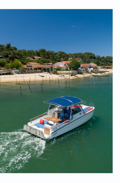
Le Pinball est un modèle bi-mode qui réunit un bateau électrique et un bateau hybride. La propulsion électrique permet une grande maniabilité et une navigation en toute discrétion sur les eaux calmes et peu profondes. Le moteur thermique transmet, quant à lui, toute la puissance et l'autonomie nécessaires pour parcourir de grandes distances à vitesse élevée. Alimentés par une batterie Lithium de 20 kWh, les deux moteurs électriques assurent jusqu'à 2h de navigation à 4 nœuds et 1h20 à 5 nœuds.
